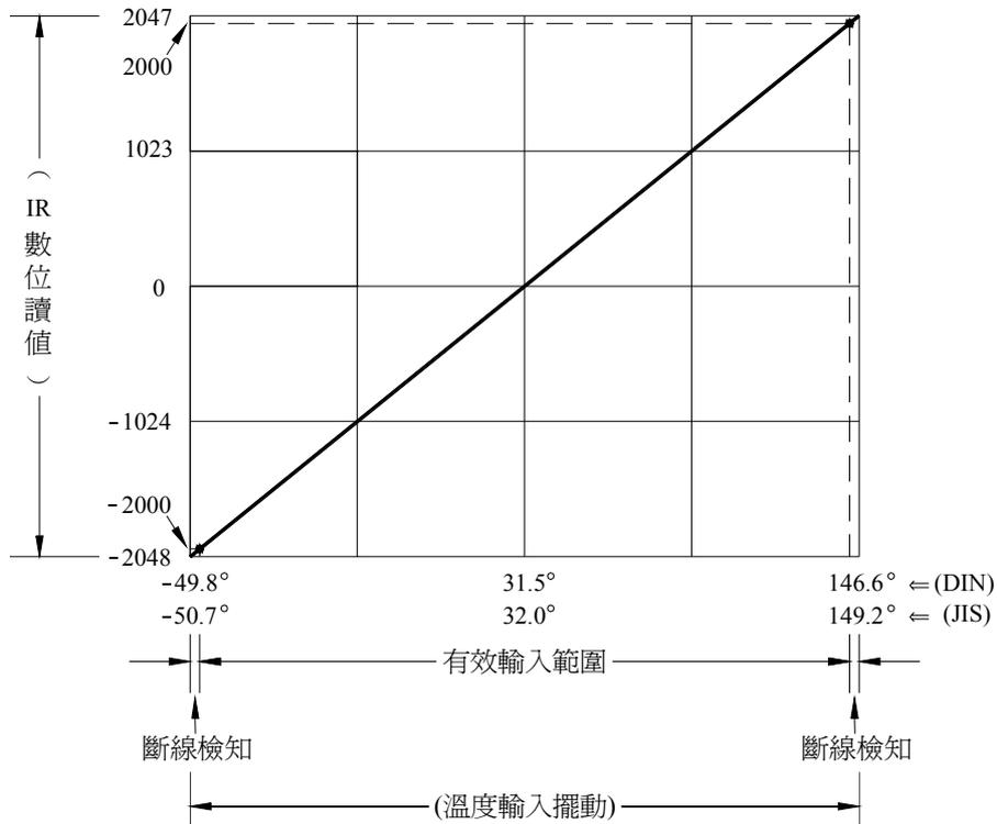
圖二：雙極性  $-12.3^{\circ}\text{C} \sim 83.6^{\circ}\text{C}$  (DIN)、 $-12.5^{\circ}\text{C} \sim 85.1^{\circ}\text{C}$  (JIS) 範圍
