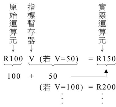
如上圖示，只要變更 V 之值即可變更運算元之位址，利用此功能結合 FB-PLC 之應用指令，您可以極簡易之指令，達成功能強大、極具效率之控制應用，如下圖程式例，您只須以一個區塊搬移指令（BT\_M）即達成諸如停車管理系統之動態區塊資料顯示。
