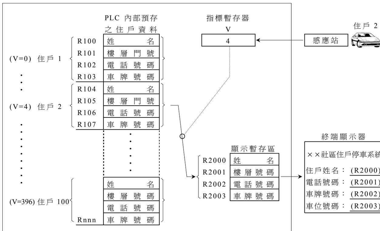
**程式說明：** 上例假設某社區住戶之自動化停車場管理系統，共有 100 個住戶停車位，每個住戶均有 1 組基本資料，分別為住戶姓名，電話號碼，車牌號碼，停車位號碼等 4 個，每組資料如上圖示佔用連續 4 個 PLC 內部暫存器，共佔用 R100~R499 等 400 個暫存器，每個住戶均有一不同卡號之卡片，以供進出口門禁及停車場進出之感應通行使用，其卡號為 0，4，……，396 等 100 種，在 PLC 感應到卡號後，將之存入指標暫存器“V”，而在管理員處之終端機（LCD 或 CRT）顯示資料則固定由 PLC 內部之 R2001~R2003 來抓取並顯示，如本例感應到住戶 2 之卡片，其值=4，因此 V 暫存器=4，PLC 立即將 R104~R107 之資料搬移至顯示暫存區（R2000~R2003），因此管理員處之終端機可在感應到住戶 2 之卡片之同時，立即將其資料顯示在終端機上。
