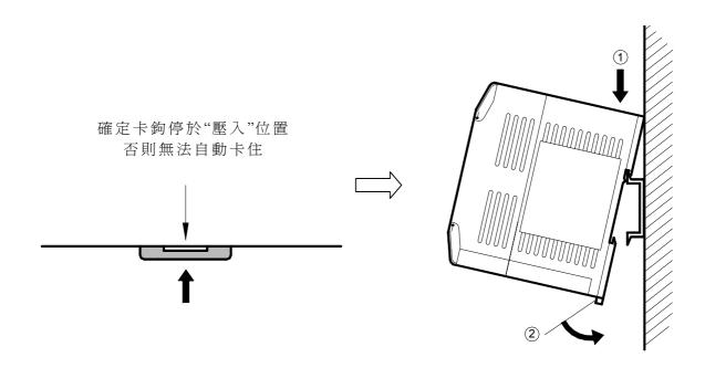
取下 以長柄一字起子伸入 DIN RAIL 卡鉤之凹洞內,再將起子以扭轉或推拉方式將卡鉤拉 出,使之停在"拉出"位置,即可取下 PLC,如下圖示。
