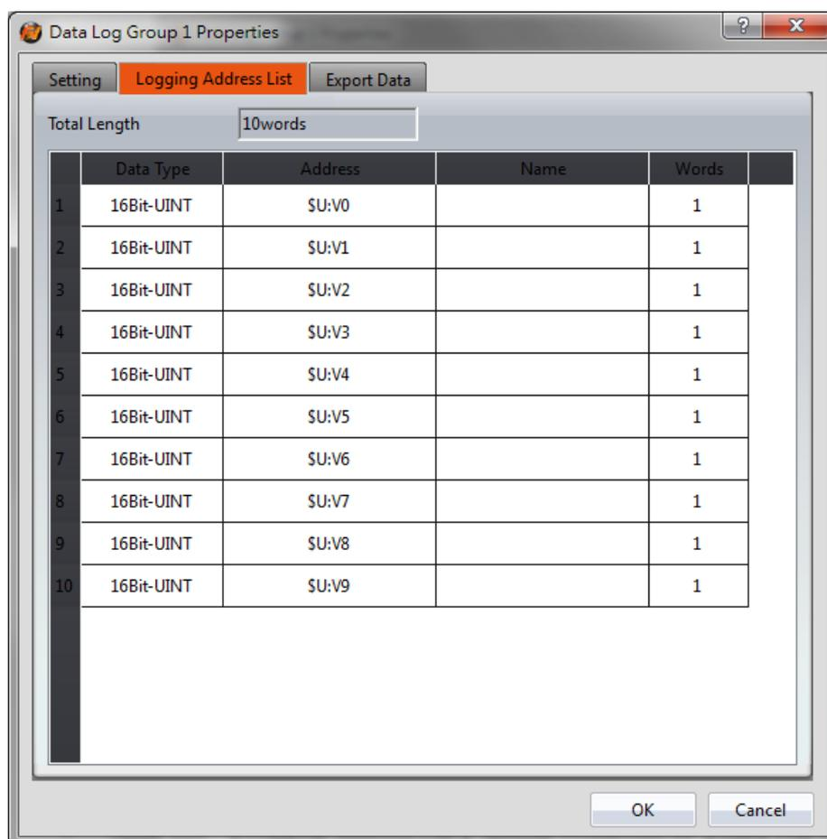
Figure 179 【Logging Address List】 Setting Screen of 【Data Log Group】
