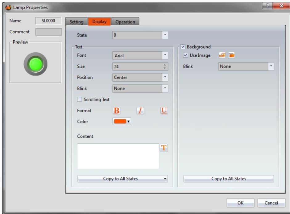
Figure 76 【Display】 Setting Screen of 【Lamp】
