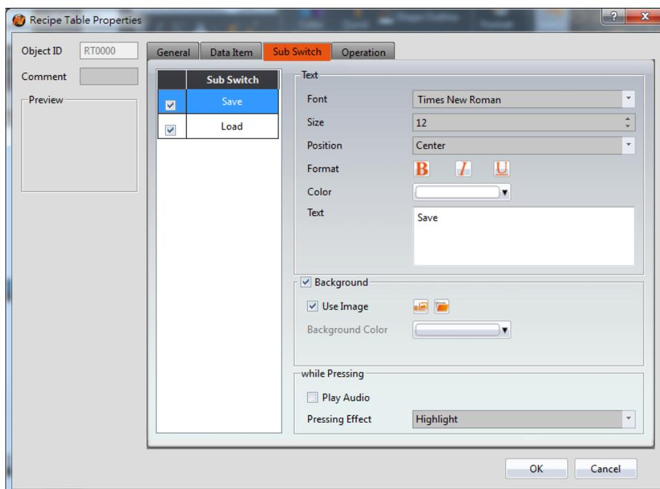
Figure 161 【Sub Switch】 Setting Page of 【Recipe Table】
