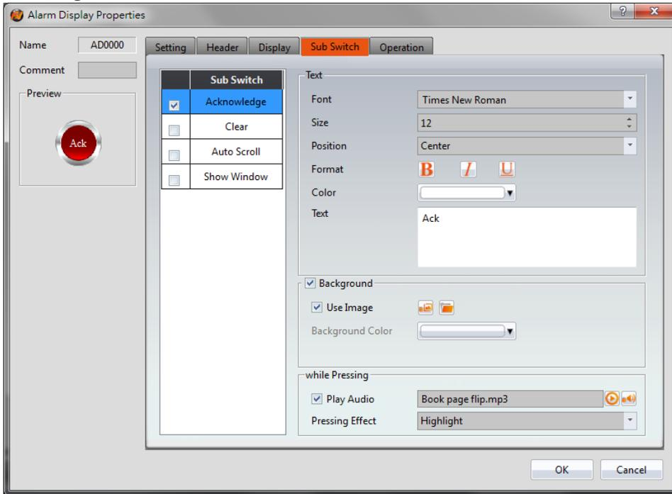
Figure 152 【Sub Switch】 Setting Screen of 【Alarm Display】
