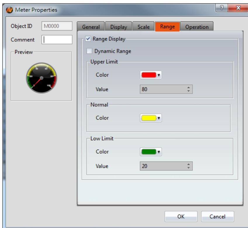
Figure 99 【 Range 】 Setting Screen of 【 Meter 】
