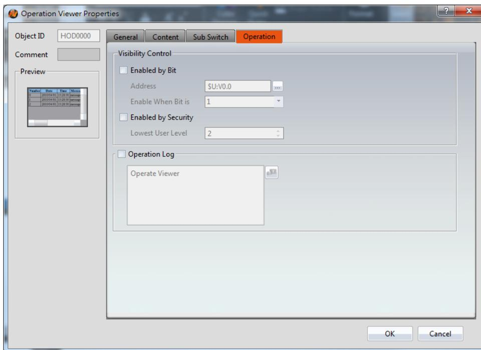
Figure 166 【 Operation 】 Setting Screen of 【 Operation Viewer 】
