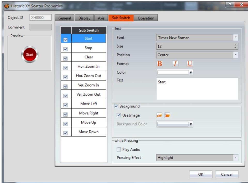
Figure 143 【Sub Switch】 Setting Screen of 【Historic XY Scatter】
