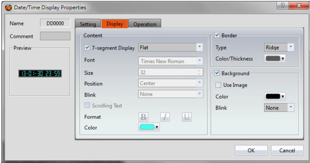
Figure 92 【Display】 Setting Screen of 【Date/Time Display】
