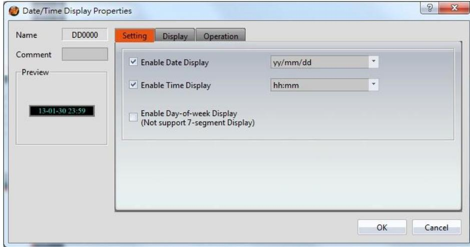
Figure 91 【Setting】 Screen of 【Date/Time Display】
