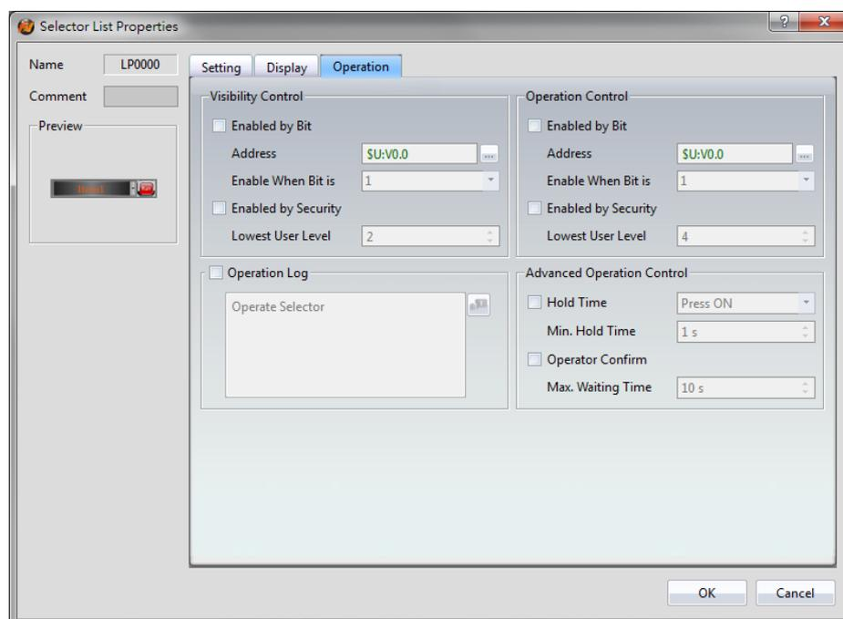
Figure 124 【Operation】 Setting Screen of 【Selector List】
