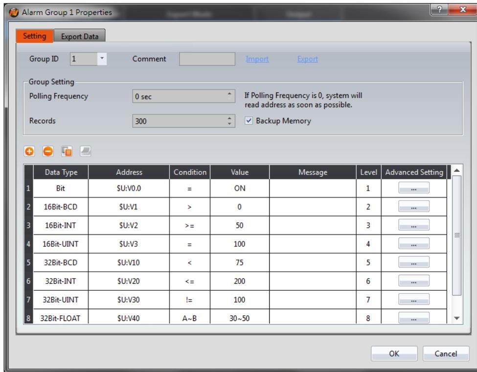
Figure 182 【Setting】 Screen of 【Alarm】
