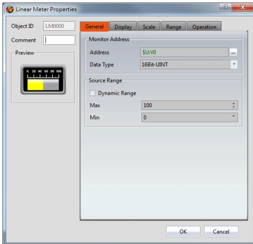
Figure 101 【 General 】 Setting Screen of 【 Linear Meter 】
