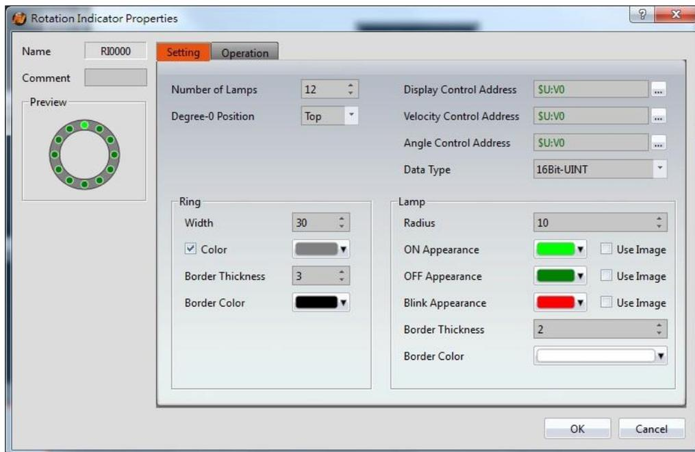
Figure 133 【Setting】 Screen of 【Rotation Indicator】
